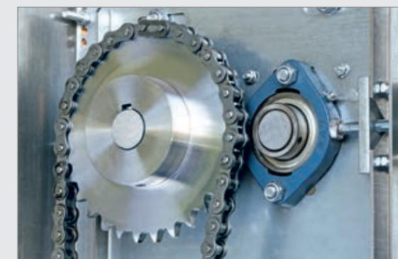
Rodamiento abridado con carcasa de fundición
