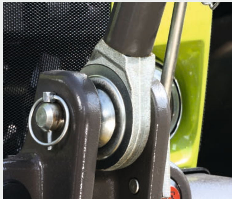
Vielfältiger Einsatz von Gelenklagern an Traktoren
